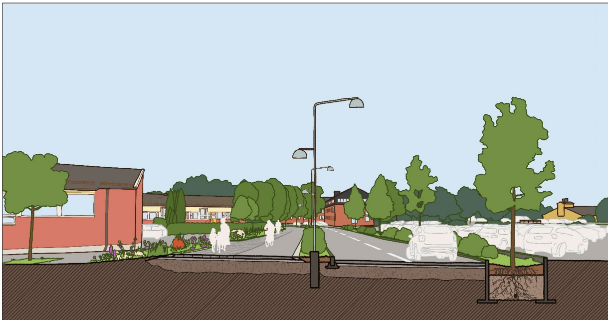
Figur 14. Illustrationen visar en sektion för den nya föreslagna Tapprömsvägen. Längst till höger i bilden syns den befintliga infartsparkeringen. Rakt fram syns Ekerö kommunhus och till vänster syns skolområdet. Mellan den nya körbanan och infartsparkeringen föreslås en grön gestaltad dagvattenanläggning som möjliggör för plantering av enkelsidig trädallé och mindre vegetation såsom exempelvis buskar. Mellan den nya körbanan och cykelbanan föreslås en möbleringszon för bland annat plantering av vegetation och placering av belysningsstolpar. Möbleringszonen är tänkt att även fungera som en fysisk separering mellan oskyddade trafikanter och motorfordon. För att förtydliga vilken yta som är avsedd för gående och cyklister föreslås gångbanan och cykelbanan ha olika beläggningar. Längst till vänster i bilden, mellan skolområdet och den nya gång- och cykelvägen föreslås plantering av ängsvegetation (en grön zon) för att skapa en mer inbjudande entré till skolorna.
