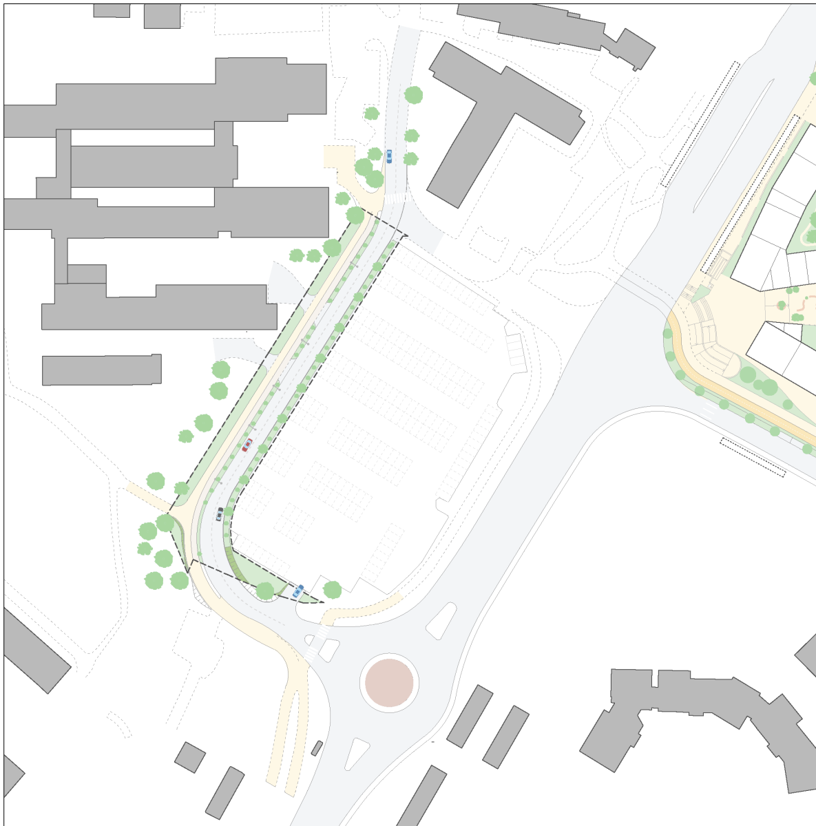
Figur 12. Illustrationen visar föreslagen dragning av Tappströmsvägen och den nya anslutningen till Ekerövägen via cirkulationsplatsen vid Clas Horns väg. En ny separerad gång- och cykelväg föreslås
